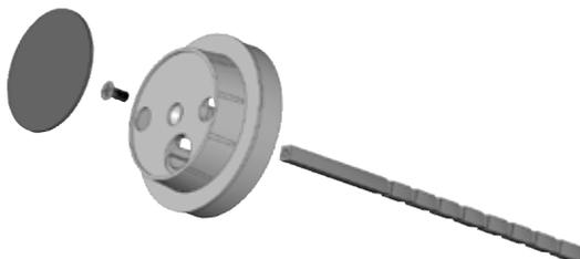
Abb. 4: Verbindung Zahlenknopf/Vierkantspindel
