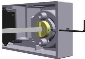
⑤ **Verbindungskabel der Bedieneinheit** durch die Tür zum Schloss führen.
