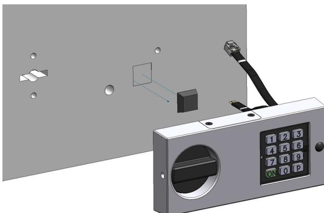
③ **Antriebswelle** mit der gebohrten Seite voraus ins Schloss bis Anschlag einführen (nur so ist die Schlossfunktion sichergestellt).
