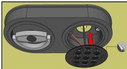
**Nach Einkleben der Tastatur diese nicht noch einmal entfernen und neu einsetzen !**
