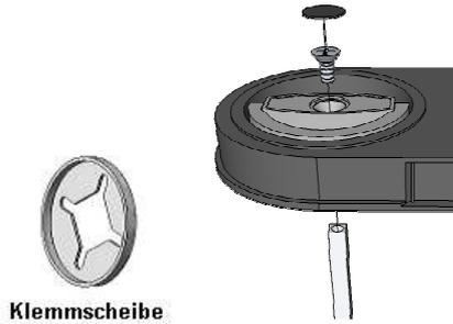
Kürzen Sie die 8mm Vierkantspindel auf die gewünschte Länge. Zu empfehlen ist, das Ende der Spindel leicht abzukanten, um es leichter im nächsten Schritt in das Schloss/Riegelwerk einführen zu können. Achten Sie darauf, dass die Spindel eine angemessene Länge hat, um in das Schloss oder durch das Riegelwerk zu passen.
