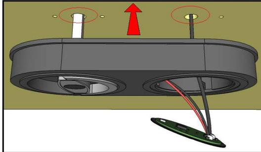
Bevor weiter zu gehen, achten Sie darauf dass das Schloss/Riegelwerk in offener Position ist. Drehen Sie den Griff so dass die Montagelöcher sichtbar sind. Tastatur senkrecht halten und Spindel und Kabel durch Löcher führen in das Schloss und Riegelwerk hinein und danach festdrücken gegen Montagefläche.
