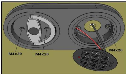
Säubern Sie die Oberfläche gründlich in die die Folien-Tastatur eingepasst wird. **Diese Fläche muss zum Einkleben sauber und trocken sein.** Führen Sie das Kabel durch die Kabelöffnung. Entfernen Sie die Schutzfolie vom Klebering auf der Rückseite der Tastatureinheit. Positionieren Sie die Tastatur und drücken Sie sie in das Gehäuse.
