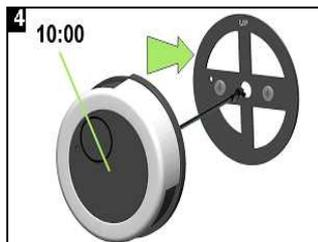
Kabel durch die Bohrung schieben und die Eingabeeinheit wie in Abb. 4 gezeigt auf die beiden Befestigungsadapter aufstecken.
