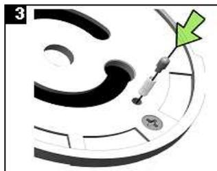
In die kleine Bohrung der Rückseite der Eingabe erst die Feder und dann den Stift einsetzen
