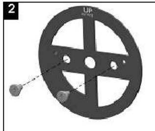
Die Lagerplatte so an der Türfläche ausrichten, dass "UP ROTATE" lesbar oben steht. Mit den zwei Befestigungsadaptern **handfest** anschrauben.
