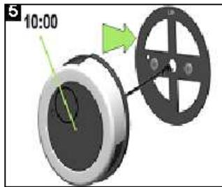
Kabel durch die Bohrung schieben und die Eingabeeinheit wie in Abb. 4 gezeigt auf die beiden Befestigungsadapter aufstecken.
