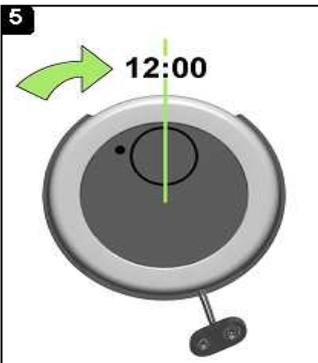
Kabeldurchführung kontrollieren und anschließend die Eingabeeinheit nach rechts drehen bis sie einrastet.
