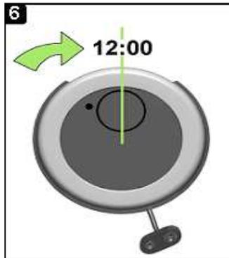
Kabeldurchführung kontrollieren und anschließend die Eingabeeinheit nach rechts drehen bis sie einrastet.
