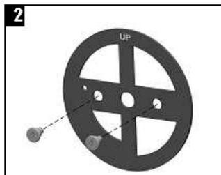
Die Lagerplatte so an der Türfläche ausrichten, dass "UP" lesbar oben steht. Mit den zwei Befestigungsadaptern **handfest** anschrauben.
