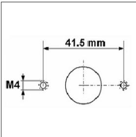
Bereiten Sie die Montagelöcher und den Türdurchbruch vor. Der Türdurchbruch und die Montagelöcher müssen so angeordnet sein, dass sich die mittige Öffnung der Grundplatte nach der Montage zentriert vor dem Türdurchbruch befindet. Beachten Sie unbedingt auch die Lage des Schlosses auf der Türinnenseite.
