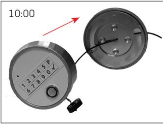
Führen Sie das Verbindungskabel durch die mittige Öffnung der Grundplatte und den Türdurchbruch. Halten Sie das Gehäuse in 10:00 Uhr-Position und schieben Sie die Nocken in die Aussparungen der Grundplatte.
