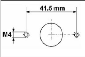
Bereiten Sie die Montagelöcher und den Türdurchbruch vor. Der Türdurchbruch und die Montagelöcher müssen so angeordnet sein, dass sich die mittige Öffnung der Grundplatte nach der Montage zentriert vor dem Türdurchbruch befindet. Beachten Sie unbedingt auch die Lage des Schlosses auf der Türinnenseite.
