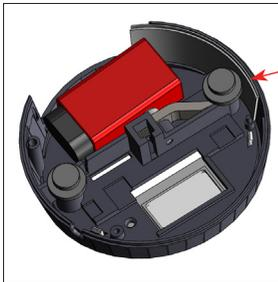
Legen Sie die Batterieabdeckung in das Gehäuse ein.
