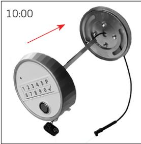
Führen Sie Spindel und Kabel durch die mittige Öffnung der Grundplatte und den Türdurchbruch. Halten Sie das Gehäuse in 10:00 Uhr-Position und schieben Sie die Nocken in die Aussparungen der Grundplatte.
