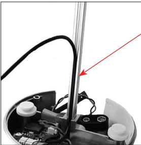
Setzen Sie die Spindel bis zum Anschlag in die quadratische Öffnung in der Mitte der Gehäuseinnenseite ein. Führen Sie das Verbindungskabel sorgfältig und vollständig in die Spindelnut ein.
