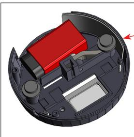
Legen Sie die Batteriefachabdeckung in das Gehäuse ein.
