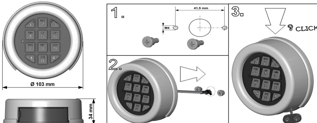
Die zwei Befestigungsadapter (Kunststoff) mit 2 M4 Senkkopf-Schrauben **handfest** anschrauben. Kabel durch die Bohrung schieben und die Eingabeeinheit auf die beiden Befestigungsadapter aufstecken. Die Rückwand muss flach auf der Tresortüre anliegen. Kabeldurchführung kontrollieren und anschließend die Eingabeeinheit **mit Druck** nach unten schieben bis sie einrastet.
