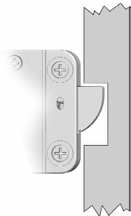
Wenn das Schloss über die Spinderbohrung montiert wird, darf die Bohrung maximal 11 mm betragen.
