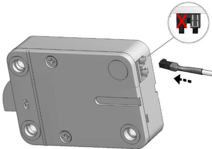
Tastaturstecker in die aussere Steckerposition am Schloss einstecken, und Arretierung prüfen. Zum Lösen den Stecker vorsichtig anheben und herausziehen.
