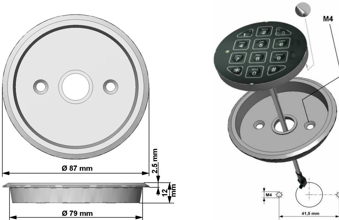
Den Gehäusering mit zwei Senkkopfschrauben M4 befestigen. Innenfläche sauber halten (z.B. Schleifstaub entfernen) und Kabel durch die Kabelbohrung schieben. Batteriekabel in Gegenrichtung durch die Bohrung führen und an den weißen Stecker in die entsprechende Aufnahme auf der Platine einrasten lassen.
