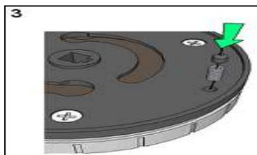
Setzen Sie zuerst die Feder und dann den Stift in das Loch der rückwärtigen Platte.
