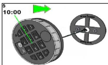
Führen Sie das Kabel durch die Kabelöffnung, halten Sie die Einheit in 10.00 Uhr-Position und schieben Sie sie auf den Montage-Schrauben.
