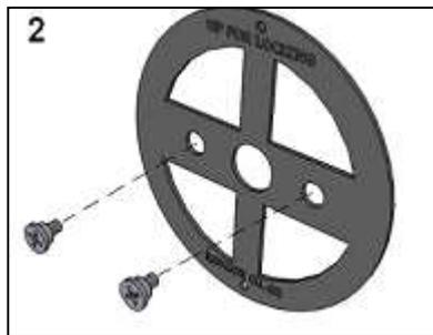
Halten Sie die Bodenplatte so gegen die Montagefläche, dass "UP FOR LOCKING" oben zu lesen ist. Befestigen Sie die Platte handfest mit den zwei **silberfarbenen** Montageschrauben.
