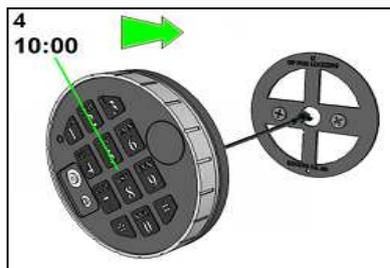
Führen Sie das Kabel durch die Kabelöffnung, halten Sie die Einheit in 10.00 Uhr-Position und schieben Sie sie auf den Montage-Schrauben.
