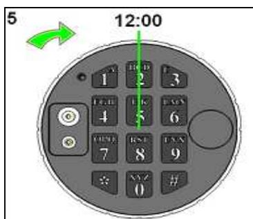
Drehen Sie die Einheit im Uhrzeigersinn bis sie in 12.00 Uhr-Position einrastet.
