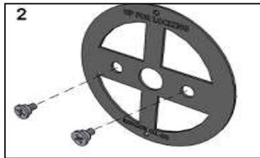
Halten Sie die Bodenplatte so gegen die Montagefläche, dass "UP TO ROTATE" oben zu lesen ist. Befestigen Sie die Platte handfest mit den zwei **messingfarbige** Montageschrauben.
