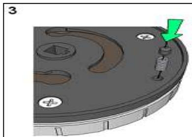
Setzen Sie zuerst die Feder und dann den Stift in das Loch der rückwärtigen Platte.
