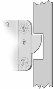
Wenn das Schloss über der Bohrung zur Kabeldurchführung montiert wird, darf die Bohrung maximal 11 mm betragen.
