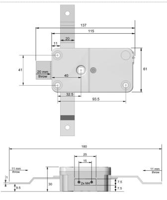
Diese Montageanleitung ist Bestandteil der VdS Anerkennung, und muss genau gefolgt werden. Der Riegeldruck soll 1 KN nicht übersteigen. (Bei höherer Belastung ist mit dem Testinstitut Rücksprache zu nehmen.) Nur die beigefügten Befestigungsschrauben (M6) verwenden, und mit flüssigem Sicherungsmittel sichern. Anzugsdrehmoment 2,5–5 Nm. Bohrung für die Kabeldurchführung 9–12 mm. Die Position der Kabeldurchführung ist abhängig von der verwendeten Eingabeeinheit.
