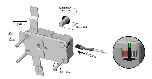
Zum Herausziehen des Steckers wird die Steckerarretierung heruntergedrückt. Eine 9V ALKALINE Duracell, Duracell Industrial- oder Energizer Batterie an den Batterieclip in der Tastatur (oder Batteriebox) anschließen, und Schlossfunktionen prüfen. Kabel von scharfen Kanten und beweglichen Riegelwerksteilen fernhalten und dauerhaft festlegen.
