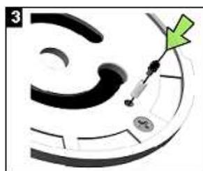
Setzen Sie zuerst die Feder und dann den Stift in das Loch auf der Rückseite der Tastatur.
