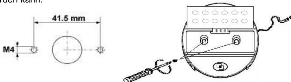
Klebeschutzfilm entfernen von der Tastatur und im markierten Bereich sorgfältig positionieren vor Befestigung.
