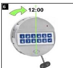
Drehen Sie die Einheit im Uhrzeigersinn bis sie in 12.00 Uhr-Position einrastet.
