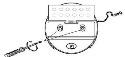
Verbinde das Kabel mit dem Schloss am "ENT" Position und montiere das Schloss.
