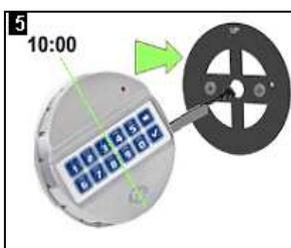
Führen Sie das Kabel durch die Kabelöffnung, halten Sie die Einheit in 10.00 Uhr-Position und schieben Sie sie auf den Montage-Schrauben.
