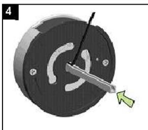
Die gekerbte Vierkantspindel mit der Schnittkante zuerst bis zum Anschlag in das Gehäuse der Eingabeeinheit schieben. Dann das Kabel ganz in die Kerbung drücken.
