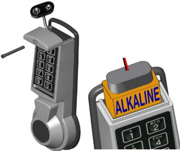
Wenn beim Öffnen eine Reihe von akustischen Signalen ertönt, ist die Batterie fast leer und muss sofort ausgetauscht werden. Verwenden Sie **nur frische 9V Alkaline Duracell, Duracell Industrial oder Energizer Alkaline Block batterie**. Zum Batteriewechsel Schraube (falls vorhanden) lösen und den Deckel des Batteriefaches nach vorne abziehen.
