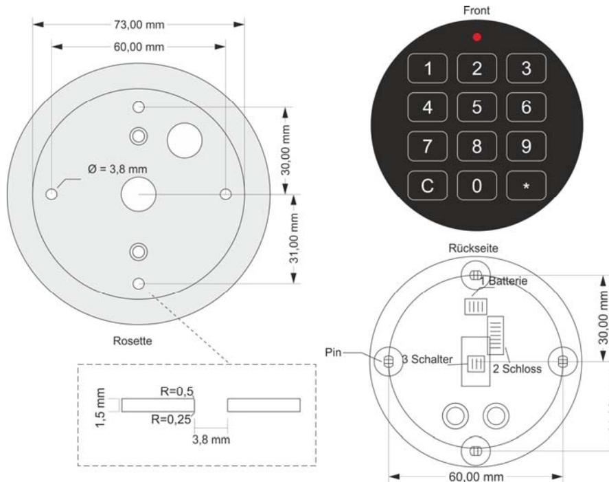
Das Tastenfeld lagerichtig über den Bohrungen für die Rastpins positionieren und durch gleichmäßigen, leichten Druck einrasten.
