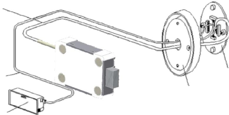
1.) Schlosskabel durch die Kabelbohrung zur Türvorderseite schieben.
