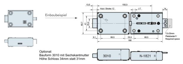
Wird nicht das Notschloss N-1821 verwendet, ist das Elektronikschloss Primor 3011 zu verwenden.
