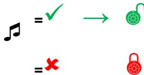
Die Eingabe des Öffnungscodes kann direkt ohne Anwahl o.ä. erfolgen. Der Riegel wird nach Eingabe eines gültigen Codes für ca. 3 Sekunden frei gegeben bzw. zurück gefahren. Öffnen Sie das Wertbehältnis nach der Codeeingabe innerhalb dieses Zeitraumes.
