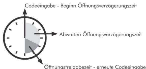
Es lassen sich Verzögerungszeiten von 1 bis 99 Minuten sowie Freigabezeiten von 1 bis 19 Minuten einrichten. Eine begonnene Öffnungsverzögerungszeit kann durch das Drücken einer beliebigen Taste abgebrochen werden.
