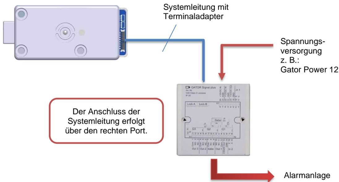
Abbildung 5 - Anschluss Gator Signal plus
