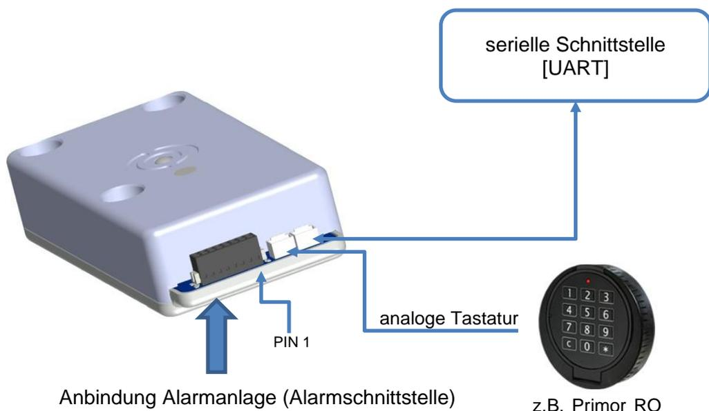
Abbildung 3 - Leitungsanschluss
