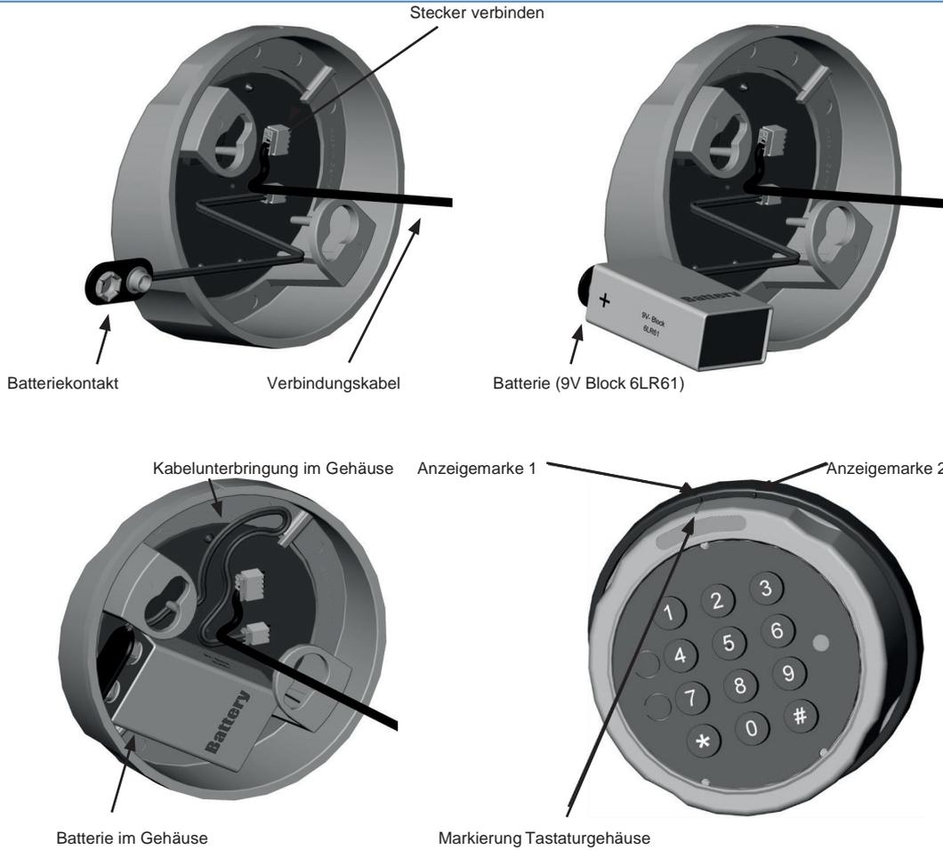
Bei Montage / Demontage des Tastaturgehäuses auf die exakte Übereinstimmung zwischen Markierung des Gehäuses und der Anzeigemarken 1 bzw. 2 achten!
