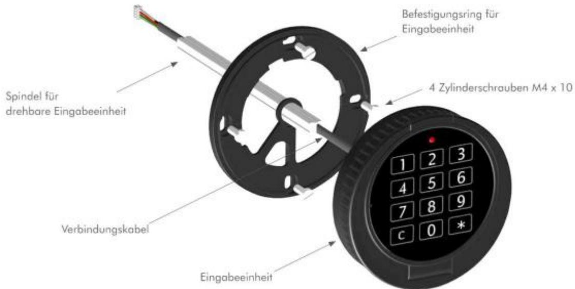
Eingabeeinheit unter einem Winkel von ca. 20° auf den Befestigungsring aufstecken (Position 1).
