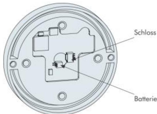
Verbindungs- und Batterieanschlusskabel nicht auf Zug belasten.
