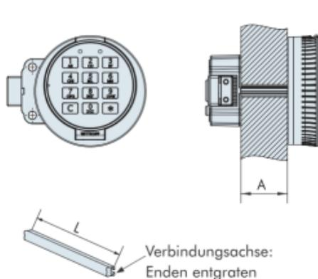
$L = A + 43 \text{ mm}$  (Toleranz -4 mm)
