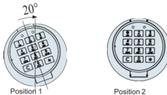
Dient die Tastatur nicht zum Antrieb des Schlossriegels oder des Riegelwerkes kann die Tastatur festgesetzt werden.
