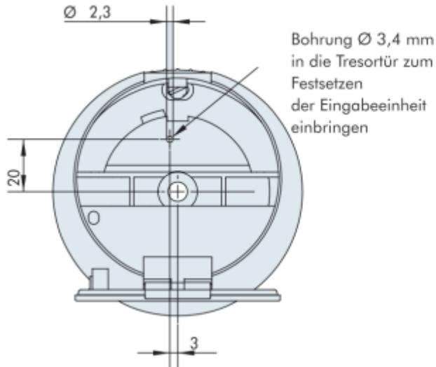
Bei Befestigungsring mit 8 Bohrungen
