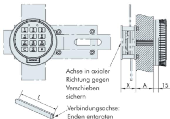
$L = X + A + 15 \text{ mm}$  (+ axiale Absicherung)
