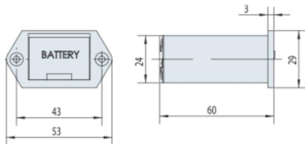
Bei dem Batterieschubfach sind die hinteren Batteriekontakte offen liegend. Zur Vermeidung eines(r) Kurzschlusses/Selbstentladung darf keine Verbindung der Anschlüsse des Batterieschubfachs mit anderen Bauteilen bestehen.
